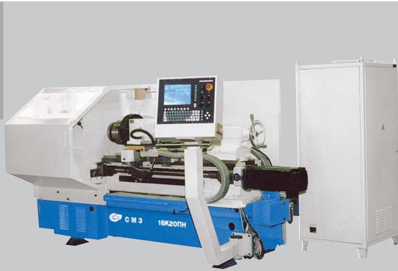
Предназначен для обработки по программе деталей типа тел вращения со ступенчатым и криволинейным профилем, включая нарезание крепежных резьб. Материал обрабатываемых деталей: все виды сталей, чугуны, легкие сплавы. Станок оснащен трехкулачковым патроном и задней бабкой. В конструкции станка применены высокоточные подшипники шпиндельных опор, суппорт повышенной жесткости, синхронные серводвигатели приводов подач, централизованная смазка.
